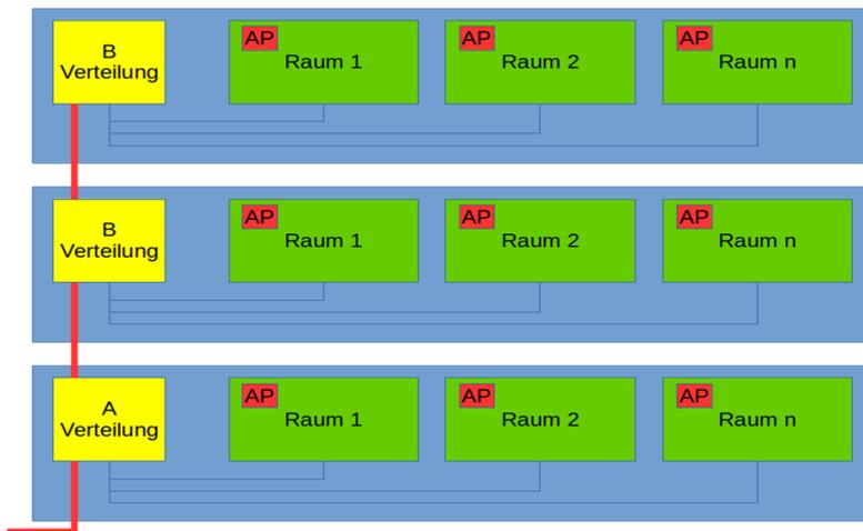
In Gebäudeteilen sind zentrale Verkabelungspunkte sinnvoll, die in brandhemmenden Netzwerkschränken nach dem gängigen Stand der Technik einzurichten sind.
